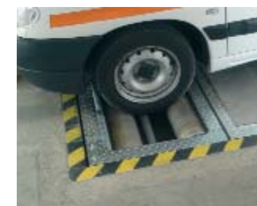
5 Duplo kombinált fék-, lengéscsillapító vizsgáló próbapad
